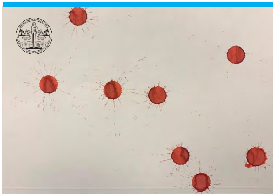
Figura 7: Imagen con manchas de sangre en 90° en una superficie de papel a 65 cm de distancia, se pueden apreciar los festones y manchas satelitales en cada una de las manchas.
